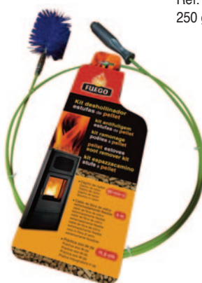
KIT DESHOLLINADOR MECÁNICO 4 CAÑAS + ERIZO 4 varillas de 1,4 m (largo total 7 m) + 1 erizo deshollinador. Ref. 1-50254. Ø 200 mm. Nylon. Ref. 1-50253. Ø 250 mm. Acero.
